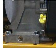
Tank leeren, Motor laufen lassen, bis auch der Vergaser leer ist und die Maschine ausgeht.
