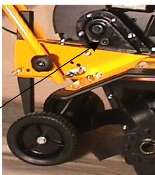
Редуктор на культиваторе заправлен на фабрике маслом 0.2 литра TEXACO Multifak EP-0 oil.
