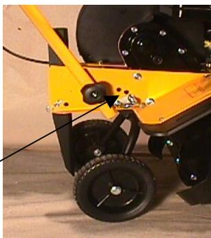
Les roues de transport ont été montées à l'usine. Vous pouvez régler la hauteur des roues en sortant la poignée de blocage, et puis trouver la position souhaitée.
