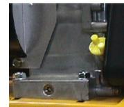
Удалите все топливо из бака, запустите двигатель до его полной остановки, пока остаток топлива в карбюраторе не будет исчерпан.
