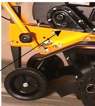
De kettingkast is gevuld met 0,2 liter TEXACO Multifax 283 EPOO olie, oliewissel is niet nodig.
