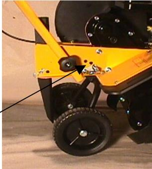
Die Motorhacke wird mit montierten Stützrädern geliefert. Die Einstellung erfolgt über einen Handhebel. Den Handhebel ausziehen und die Hacke bis zur gewünschten Höhe anheben oder absenken. Handhebel loslassen.
